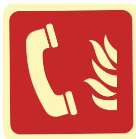
TELEFON ALARMOWANIA POŻAROWEGO
